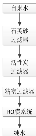
图 2-1 纯水制备工艺流程图
