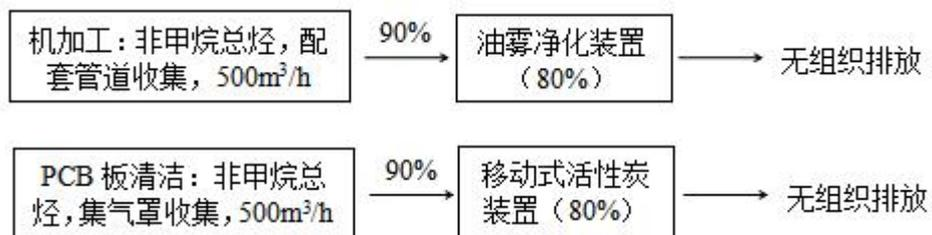
图 2-6 现有项目废气处理工艺流程图
